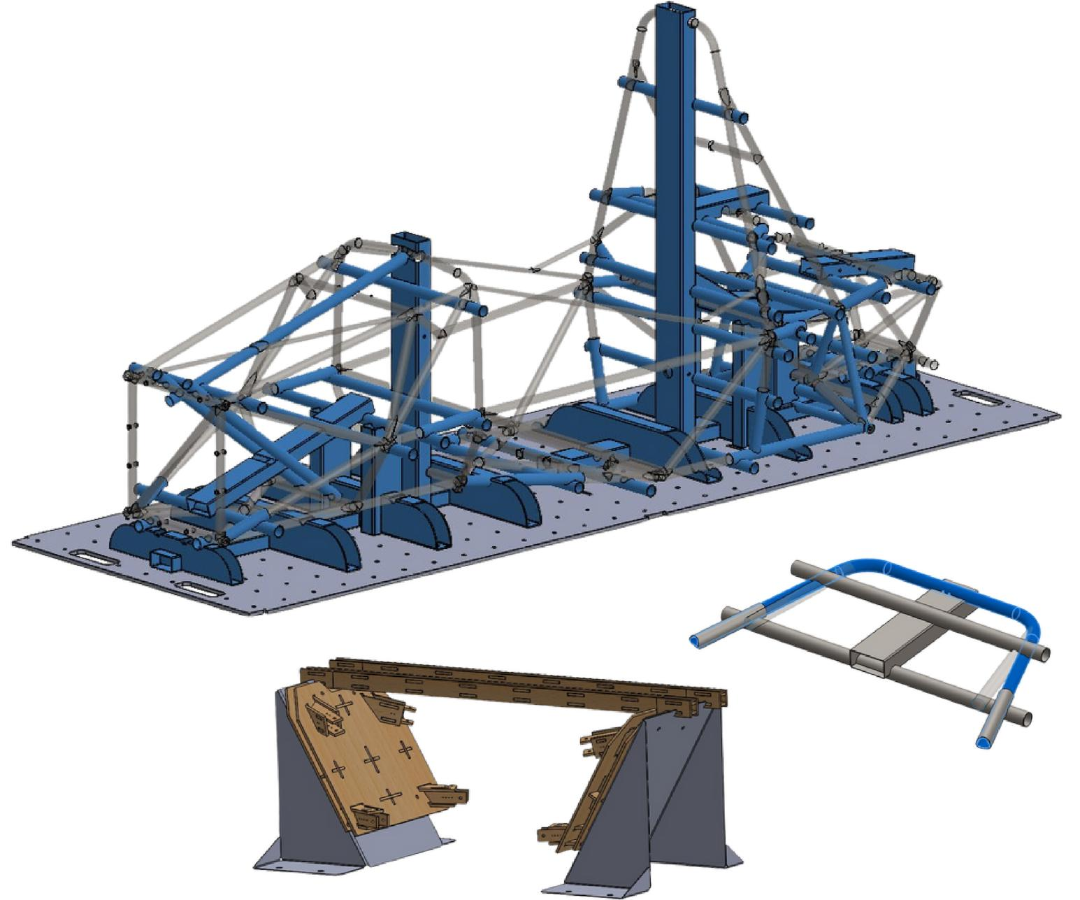
治具以標準圓管和方管為主，取代以往的鈑金治具，管類幾何不僅帶來更高的剛性也增加接觸面積，減少鈑金兩道工序累積的公差和變形的誤差，提升整體精度，此外也降低了加工時間和金錢成本。
