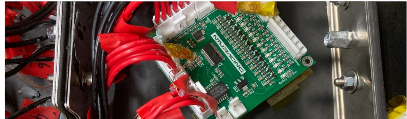
Epsilon 4 首次使用自行設計的電池管理系統，以LTC6811晶片作為電池模組溫度與電壓監測板。感謝**佳必琪國際**提供高壓電纜與安全接頭，也感謝**熙特爾新能源**提供電池模組與電池箱設計的技術諮詢。
