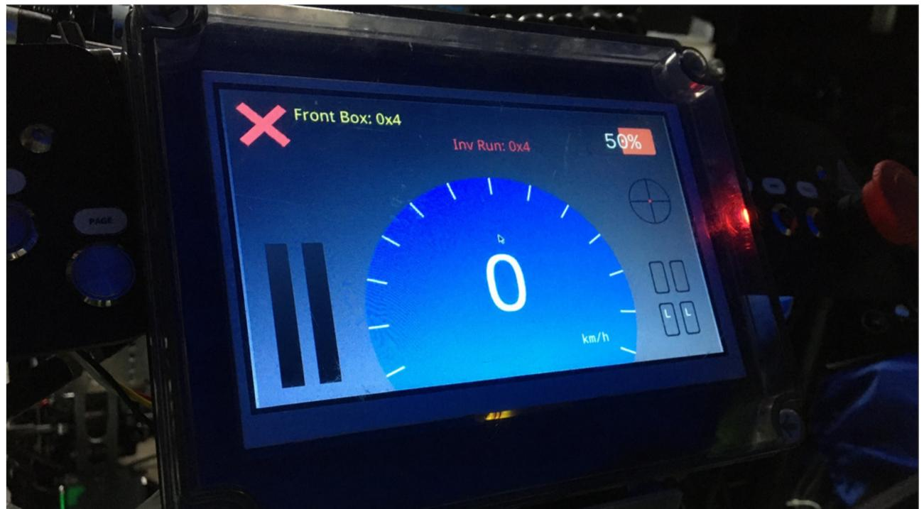
隨著搭載感測器數量的增加，在車輛運作時檢視各個感測器的數值對了解車輛表現有極大的幫助，因此我們架設了基於網路通訊的遠端塔台系統。塔台系統主要由三個部分組成：車輛上的ROS節點、伺服器和塔台終端。
